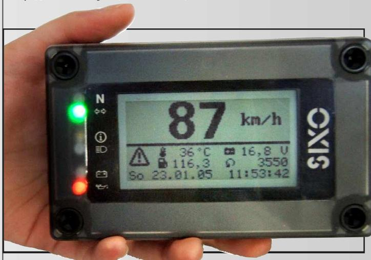
**Das komplette Universal-Instrument „SIXO“ wiegt 250 Gramm, misst BxHxT 130x79x35 Millimeter und zeigt bis 350 km/h, bzw. 15.000 U/min an.**
