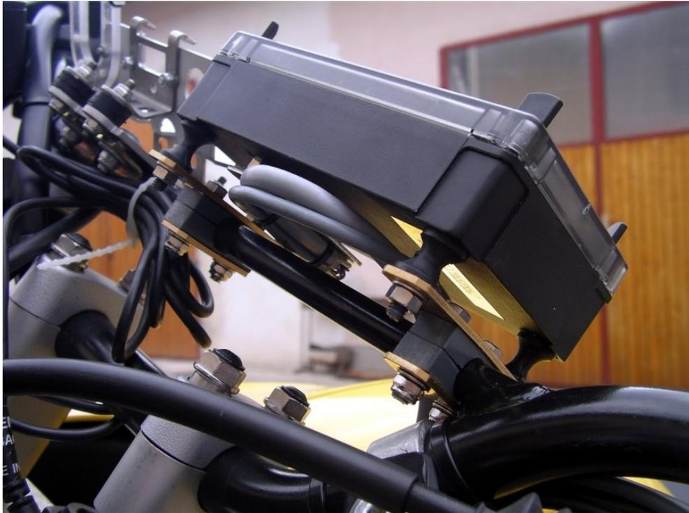
Abbildung 5: Lenkerbefestigung
